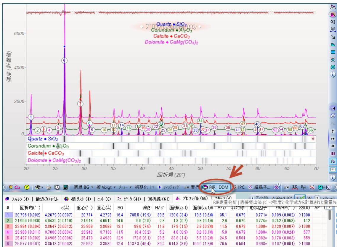
5. 同定した結晶相ごとに、定量に利用するピークを選びます。画面の上側のエリアで相を選び、下側で「フィットされたピーク」タブを選び、その相に属し定量の計算に利用したいピークにチェックを付けます。ほかのピークと重なりがなく、フィッティングの結果が良好なピークを利用するほど、定量結果の精度が上がります。
