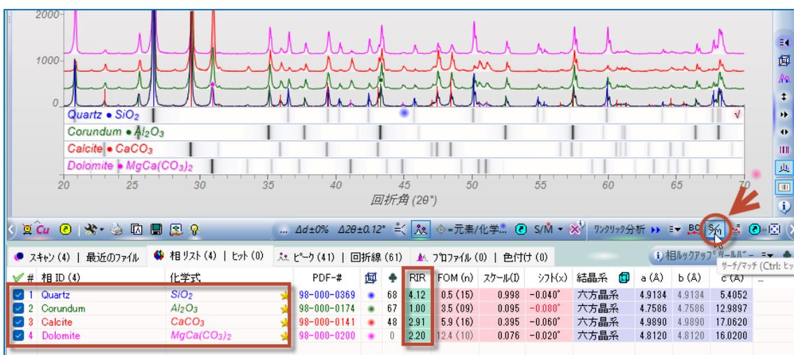
2. プロファイルフィッティングを行い、ピーク強度を求めます。「プロファイル」タブを選び、ツールバーの「メニュー」から「プロファイルの制限」→「ラインマーカー」を選ぶと、「相リスト」タブのデータのピーク位置にピークが存在するものとして、プロファイルフィッティングを行うことができます。
